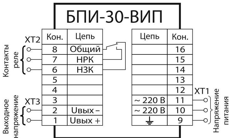
Рисунок В.1 — Схема подключения блоков БПИ-30-ВИП
